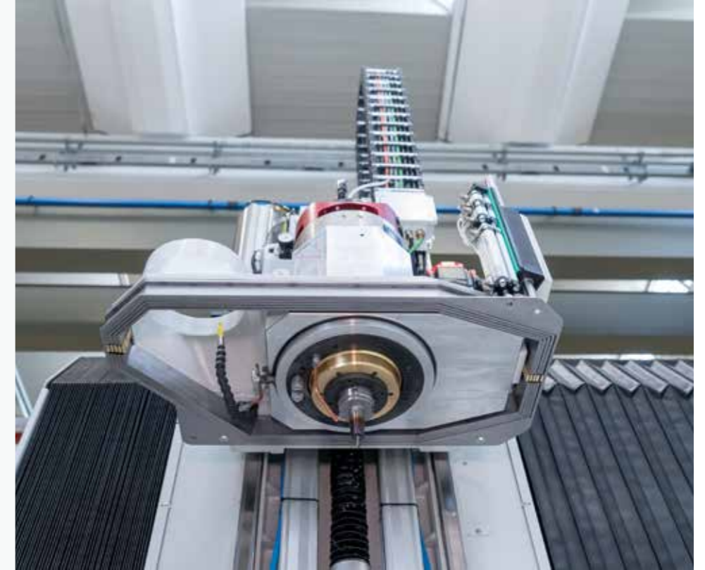
PX3 - KX3 Unités de commande pour des configurations à 3 ou 4 axes, avec des mandrins de 12 à 32 kW à 24 000 tr/min.
