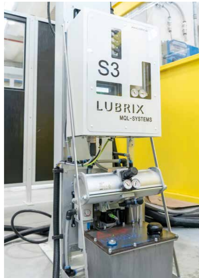
SYSTÈMES MQL Efficacité maximale avec une consommation minimale de lubrifiant. Les systèmes MQL, en association avec les mandrins électriques qui permettent le passage de l'air et de l'huile à l'intérieur de l'outil, garantissent une lubrification parfaite même dans des situations critiques.
