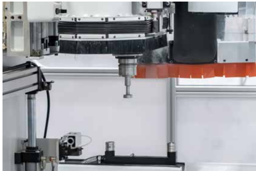
REQUALIFICATIONS Une requalification, tactile ou laser, est disponible pour calibrer les axes et mesurer les diamètres et longueurs des outils.
