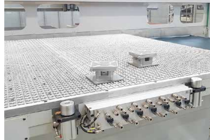
UNITÉS DE DISTRIBUTION AIR/VIDE Pour l'utilisation d'étaux, de ventouses ou sous des pièces spécifiques.
