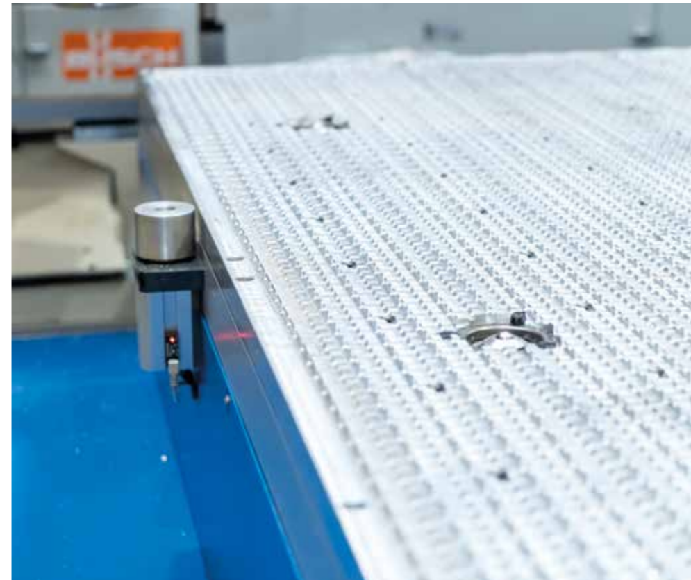
参考挡块 参考挡块（工作台外部或集成在工作台中）和集成球，有助于待加工板材在工作台上的移动，确保快速轻松地定位。
