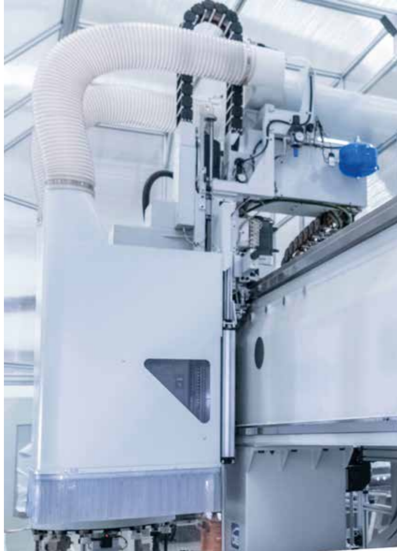
数控吸尘罩 当机床配备PX5 5轴操作单元时，可以安装用于清除加工粉尘的数控吸尘罩。
