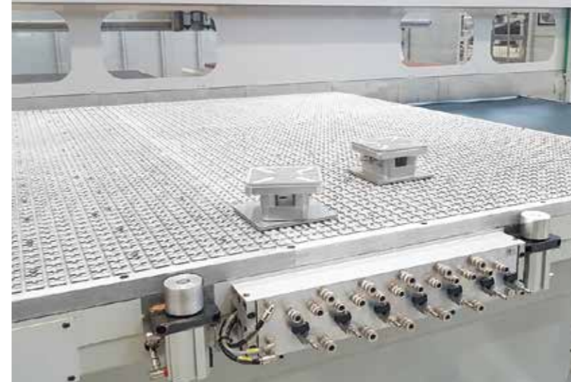
空气/真空分配装置 用于使用虎钳、吸盘或特定部件。
