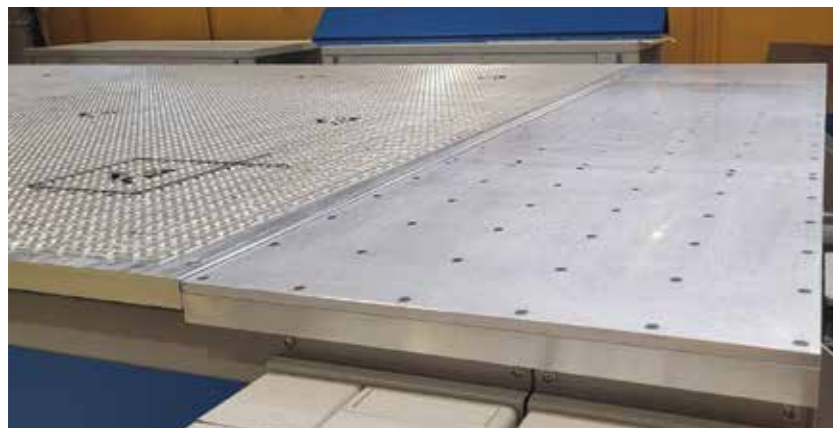
加工台面 工作台可以配置混合锁定系统（基板、Vilmill、Vacmat.....）
