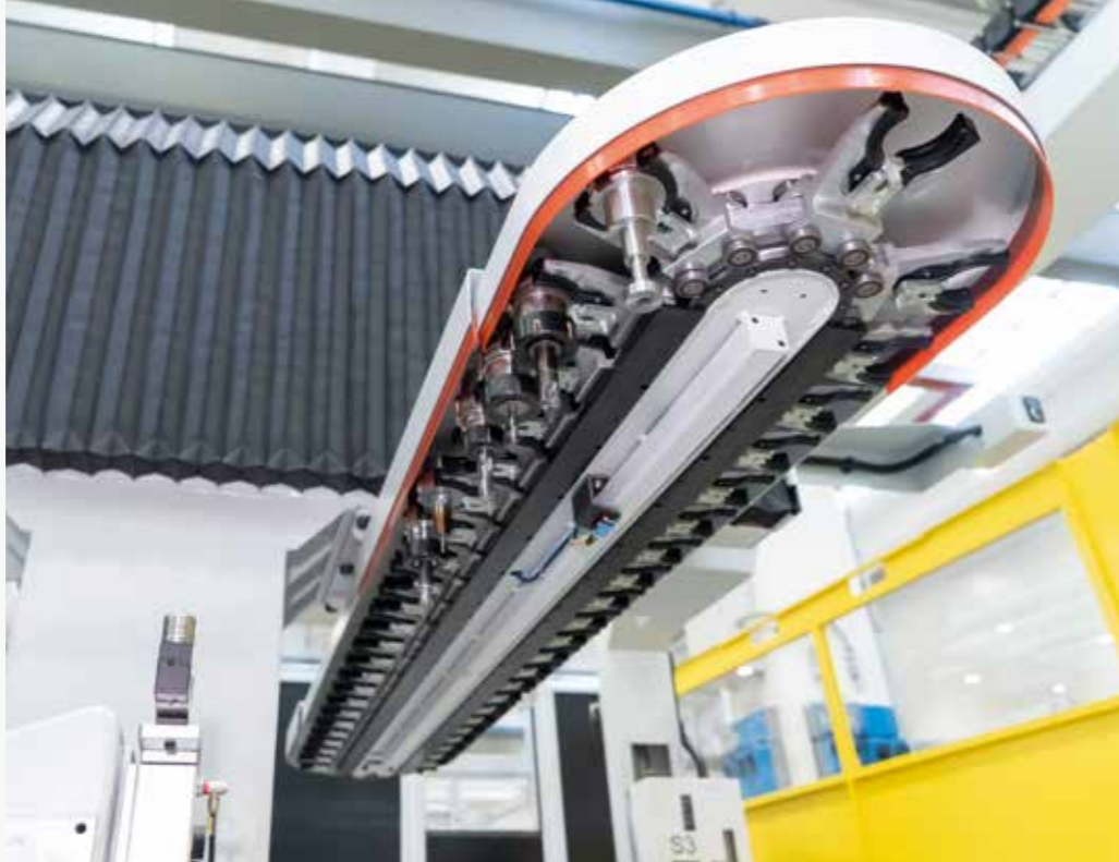
链式刀库 36位或48位刀库，可保证加工的最大灵活性和自主性。
