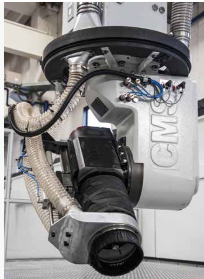
Campana de aspiración del polvo telescópica con 4 posiciones
