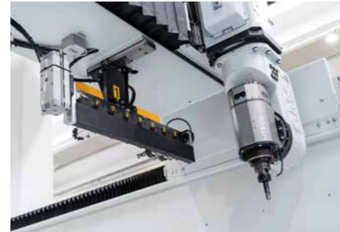
Almacén cambio de herramienta bajo el travesaño
