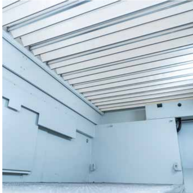
Cubierta de fuelle que limita la salida de humos, polvo y virutas del área de trabajo
