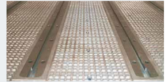
Алюминиевый всасывающий блок с Т-образными пазами
