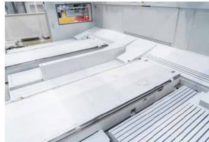
Стационарные всасывающие емкости по бокам столов
