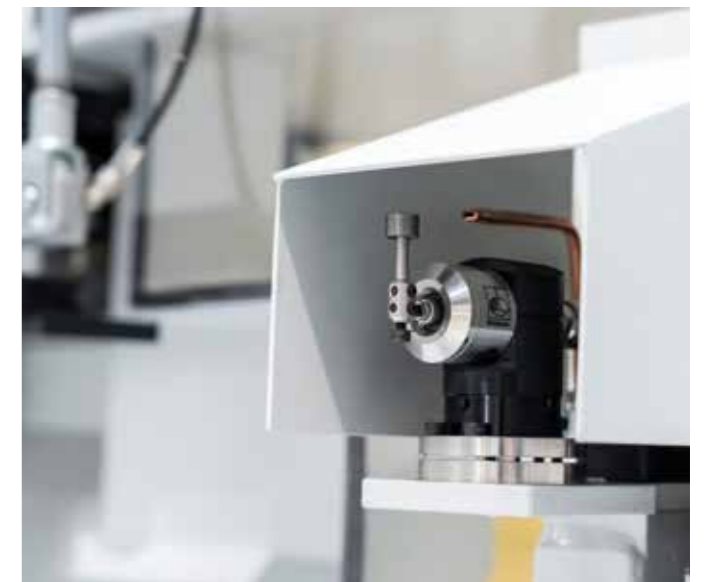
Dispositif de contrôle et de réaligement des axes rotatifs
