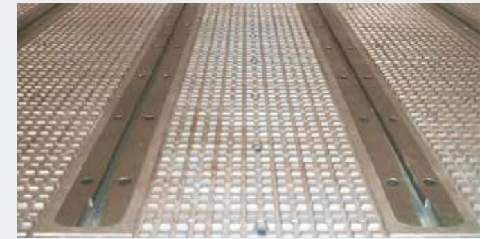
Aspirant en aluminium avec rainures en T
