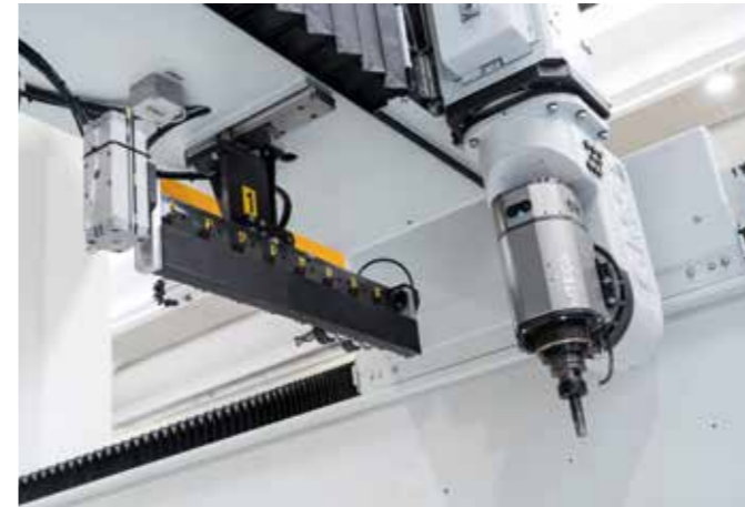
Magasin de changement d'outil sous la traverse
