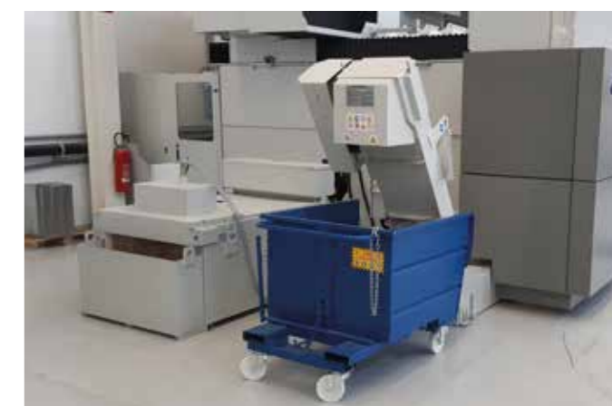
Встроенная система смазочно-охлаждающей жидкости
