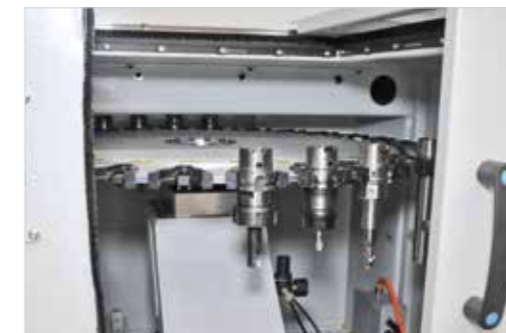
Поворотный магазин инструмента на 30 станций
