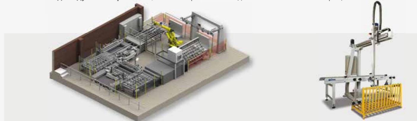
Автоматическая линия полировки и мойки стекла, где загрузку и выгрузку выполняет робот, а также система расстилания бумаги, разделяющей листы на опорной стойке.
