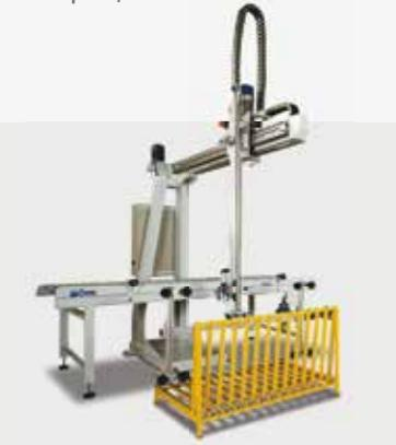
CMS Glass Technology предлагает широкий ассортимент погрузчиков и разгрузчиков для автоматического перемещения листового стекла. Все эти системы легко интегрируются с любыми прямолинейными шлифовальными машинами, обрабатывающими центрами (вертикальными или горизонтальными) и двусторонними шлифовальными машинами.
