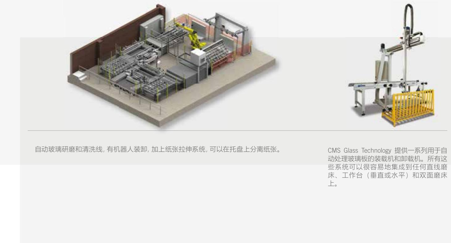
自动玻璃研磨和清洗线，有机器人装卸，加上纸张拉伸系统，可以在托盘上分离纸张。
