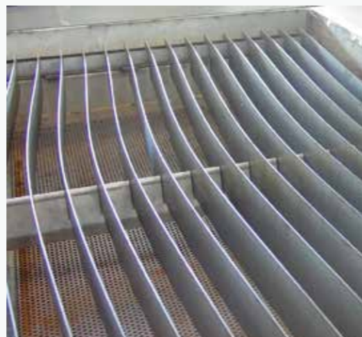
Piano antivibratorio con piatti in lamiera disposti a 35 o 70 mm (opzionale)
