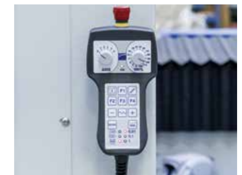
Pulsantiera remotata per controllo fino a 6 assi che consente di operare vicino al piano di taglio e di impostare multiorigini.
