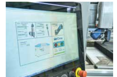
用于管理水射流切割系统的硬件和软件旨在为操作员提供简单直观的操作界面，用以全面管理系统的所有功能，包括5轴机床的锥度补偿 (JDC)。
