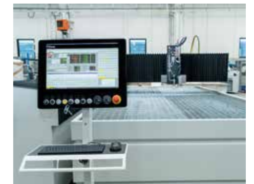
21.5英寸触屏控制台,位于活动滑架上。
