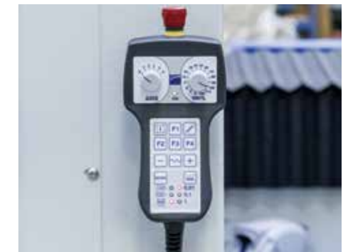
最多可控制6轴的远程按键板,允许靠近切割台操作并设置多个原点。
