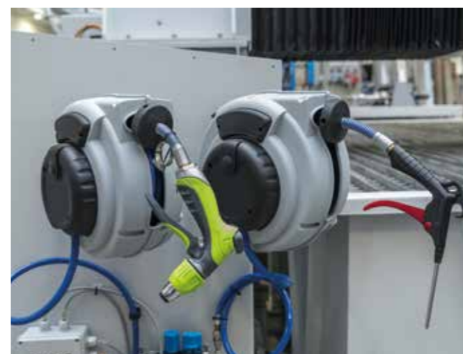
自动软管卷 水和空气喷头套件，用于在循环结束时清洁切割材料
