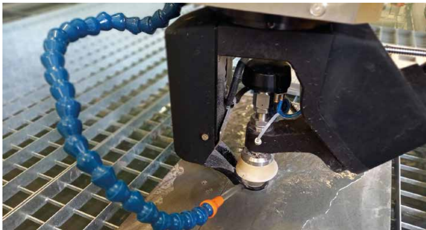
工件清洗系统 工作区清洗系统，可减少工件表面刮花的可能性，此外还可让探头正确检测材料厚度。
