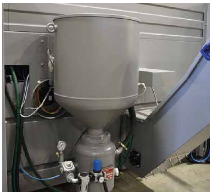
330 KG发动机 是配备两个330 kg双极储罐的磨料供给发动机。发动机固定于底座，可免除放置与安装问题，保证磨料管道的长度固定与无能耗的持续运输。双极配置保证工作状态中的机器主储罐为填满状态。
