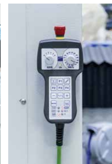
Выносной пульт для управления до 6 осями, которая позволяет работать вблизи стола резки и устанавливать несколько исходных точек.
