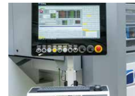
Matériel et logiciel de gestion de système de découpe au jet d'eau conçus pour offrir une interface opérateur simple et intuitive et permettre la gestion complète de toutes les fonctions du système, y compris le contrôle du cône (JDC) pour les machines à 5 axes.
