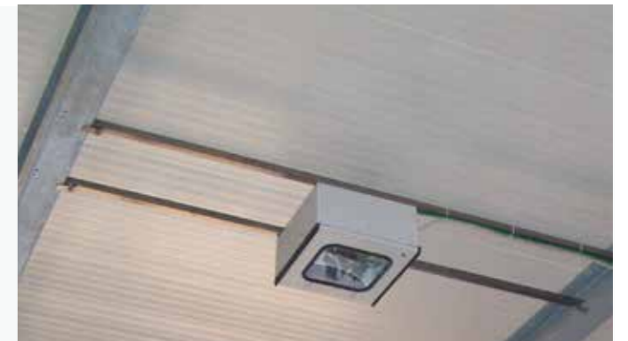
Система для получения изображения с рабочего стола. Ускоряет позиционирование деталей и выявляет возможные дефекты слэба.
