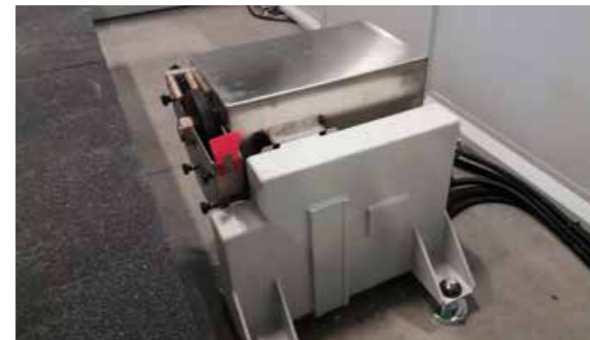
Узел подрезки нижней части слэба, для гравировки нижней стороны плиты; Позволяет вставлять опоры столешнице. Может оснащаться сверильным устройством для выполнения отверстий для крепления столешниц на кухне / в ванной. Операции управляются автоматически и требуют использования вакуумного манипулятора.
