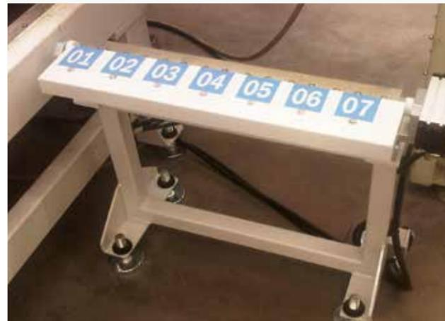
Troca de utensílio magnético para brocas com armazém específico de 6 posições.
