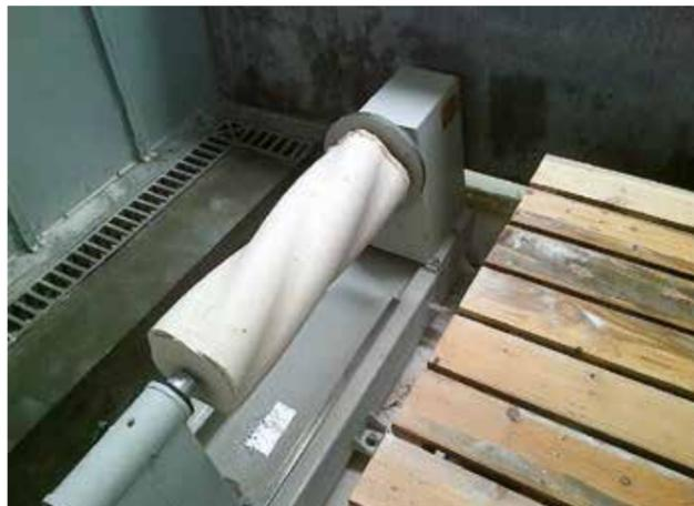
Gama de tornos capazes de satisfazer todas as exigências do laboratório:  $\varnothing$  700 mm – 700 kg /  $\varnothing$  1.200 mm – 5.000 kg /  $\varnothing$  1.500 mm – 10.000 kg
