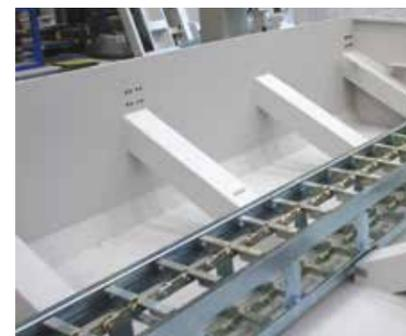
Sistema de dragagem “sem manutenção” para a remoção automática do abrasivo exausto. O sistema de evacuação do abrasivo, no interior do tanque, está protegido por cestos para a recolha dos desperdícios de laboração e por uma gaiola metálica. O tanque está sempre predisposto para poder instalar posteriormente todo o grupo de dragagem.
