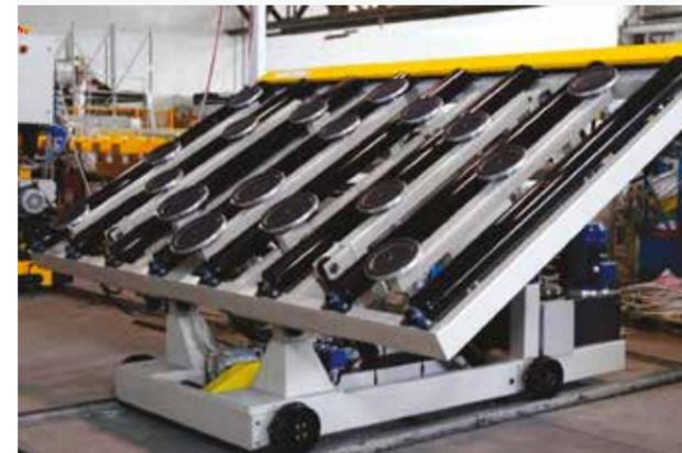
Carregadora automática de ventosas deslizante sobre carris, para apanhar placas de pedra de uma paleta porta-placas vertical, sucessivo rebatimento em posição horizontal para o envio na linha de laboração. Solução aplicável também para versão com tapete.
