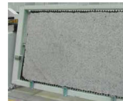
Bancada rebatível hidráulica para facilitar o carregamento vertical das placas.
