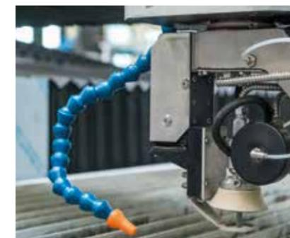
Cabeça de corte de 5 eixos com tecnologia IKC - Intelligent Kerf Compensation - Eficaz movimentação da cabeça para realizar cortes inclinados e controlar a conicidade do sulco de corte.
