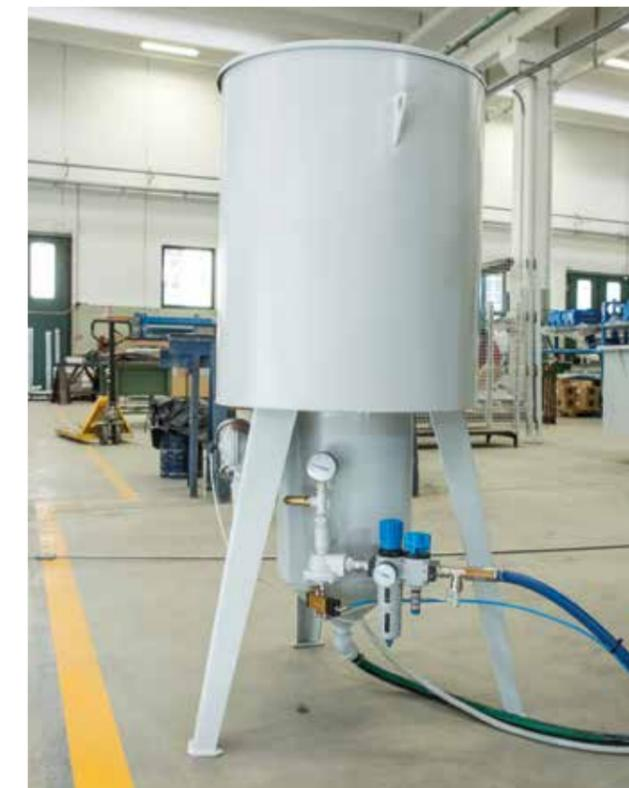
Propulsor de abrasivo de 330 kg de capacidade para a alimentação do abrasivo equipado com dois depósitos: um com uma capacidade de 330 kg e outro, pressurizado, para alimentar a cabeça de corte (doseador eletrónico). Está disponível também na versão de duplo estágio de 2000 kg que permite acabar trabalho demorados sem interrupções devidas a falta de abrasivo com consequente danos no material.
