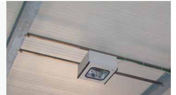
用于获取工作台图像的系统 它可以加快工件的定位并测出板材上可能存在的缺陷。
