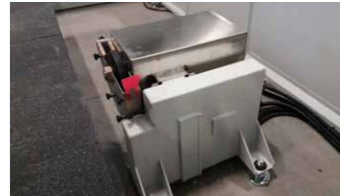
从下方切割的单元,用于在板材的下表面上切开切口,以便插入用于厨房台面的加固件。还可以从下方通过钻孔装置进行扩展,方便钻盲孔,用于厨房/洗手间台面的固定。这些操作由机床自动控制,需要使用带吸盘的机械手。
