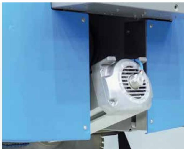
Protezioni posteriori complete in lamiera, a norma CE, in grado di resistere alla possibile eiezione di frammenti di lavorazione o di utensili.
