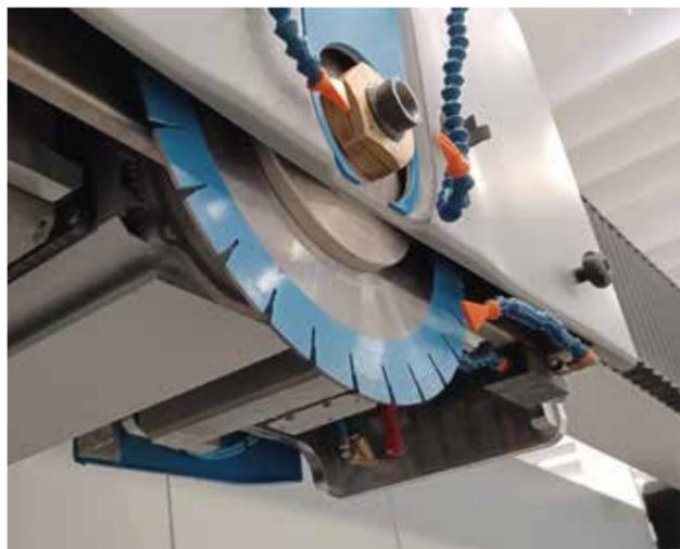
Elettromandrino gestito da inverter che consente la regolazione del nr. di giri da 0 a 6.000 rpm. Consente l'utilizzo di utensili diamantati quali frese a candela o foretti. Il cambio utensile è manuale.
