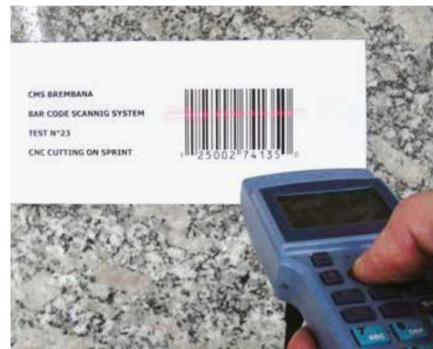
Letttore codici a barre fornito completo di software dedicato per la lettura del codice e richiamo del programma di lavorazione.
