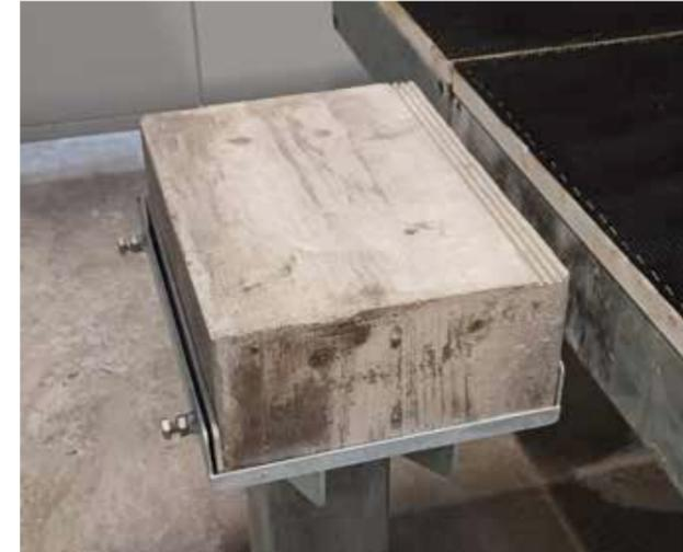
Unité d'aiguisage automatique du disque diamanté.
