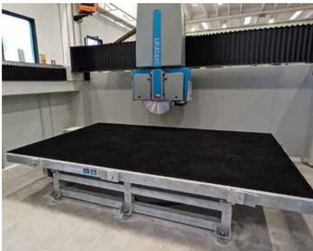
Table d'usinage, fixe ou basculante, protégée contre la corrosion par galvanisation à chaud, avec plan de travail en caoutchouc ou bande de découpe, associable à des extensions en option pour permettre le déplacement des pièces en cas de coupes interférences.
