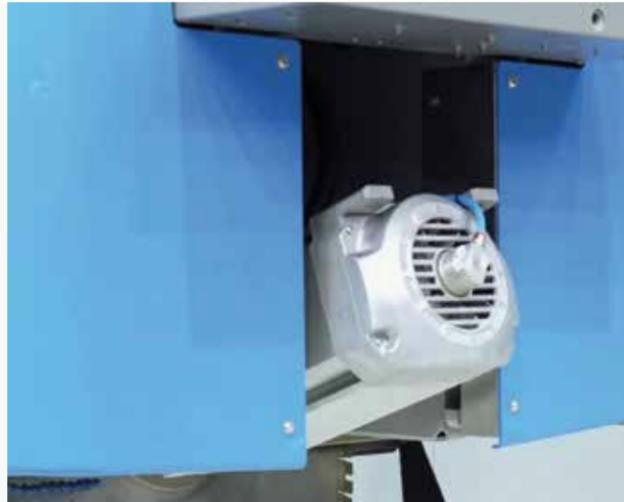
Protections arrière complètes en tôle, conformes à la norme CE, capables de résister à l'éventuelle projection de fragments d'usinage ou d'outils.
