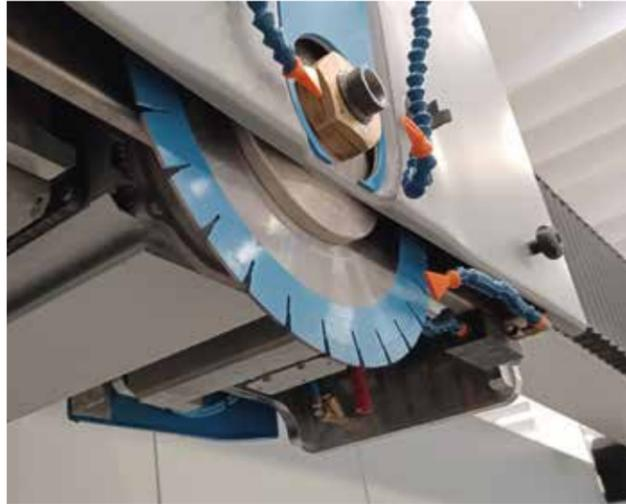
Électro-broche commandée par inverseur, qui garantit le réglage du nombre de tours de 0 à 6 000 tours/minute. Elle permet l'emploi d'outils diamantés tels que les disques à cannelures ou forets. Le changement d'outil est manuel.
