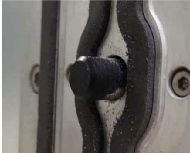
Palpeur d'épaisseur de dalle pour la détection automatique de l'épaisseur de la pièce en pierre ou en céramique, intégré dans le manipulateur à ventouses.
