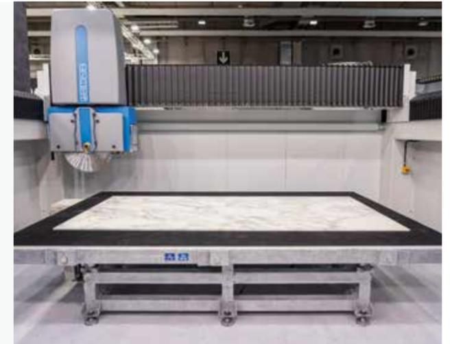
Laser à croix utilisé pour obtenir un gabarit bidimensionnel qui peut servir pour les usinages ultérieurs.
