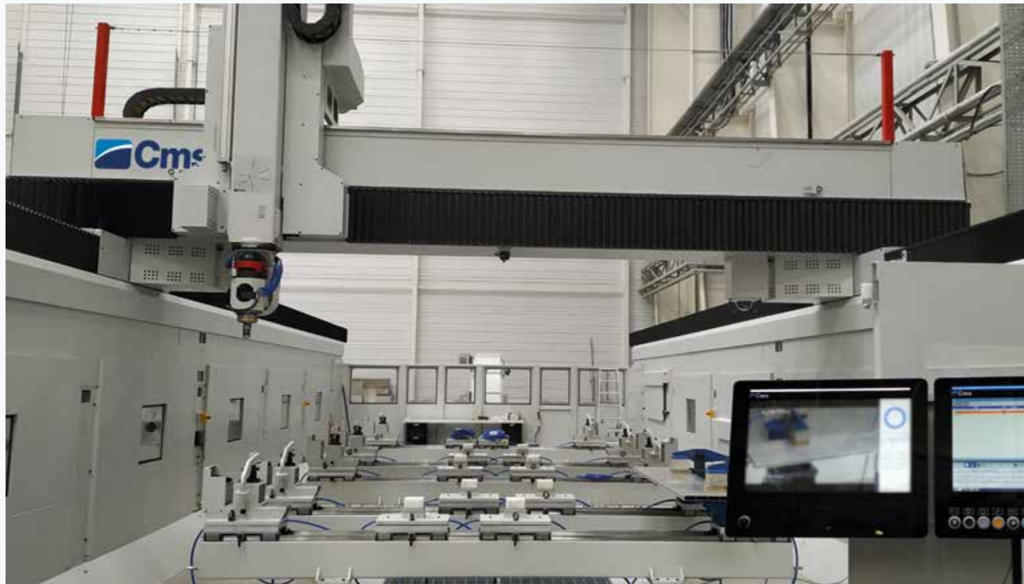
Нулевая точка для быстрой и точной установки сменных компонентов
