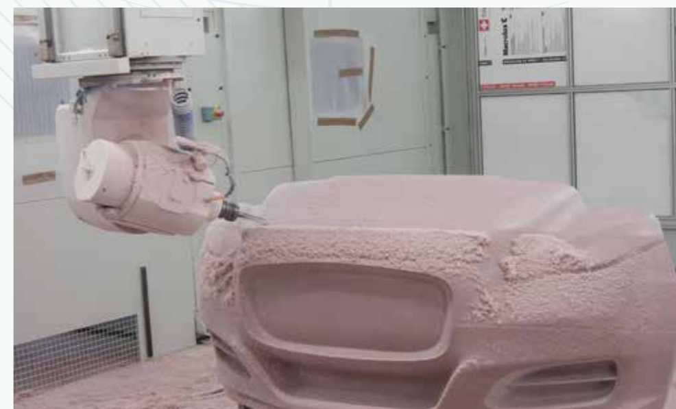
Изготовление модели автомобиля из полимерной смолы.
