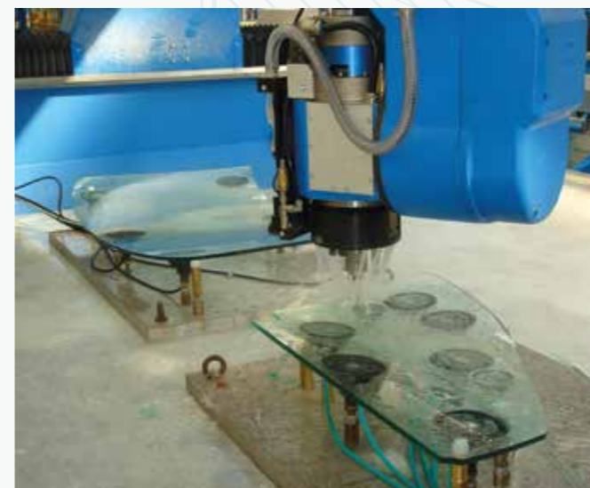
Изготовление лобового и бокового стекол автомобиля
