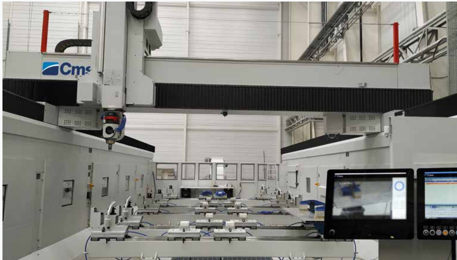
Punto cero para una instalación rápida y precisa de componentes intercambiables
