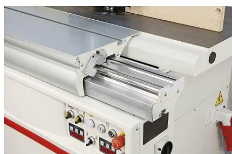
Регулируемая фрезерная направляющая линейка с засечками для быстрого позиционирования и индикатором положения для микрометрической регулировки
