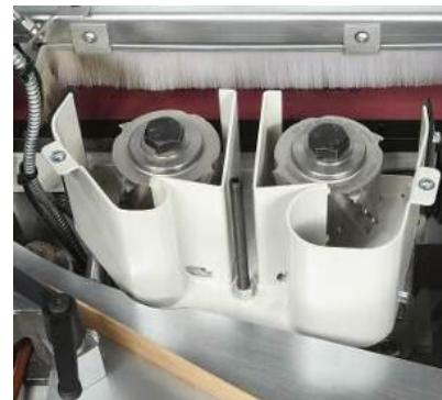
**Комплект алмазного инструмента для узла прифуговки****КЛЕЕВОЙ УЗЕЛ, УЗЕЛ ПОДАЧИ И ПРИКАТКИ КРОМКИ**
