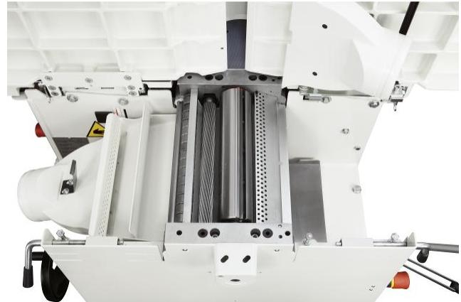
Винтовой подающий ролик на входе рейсмуса
