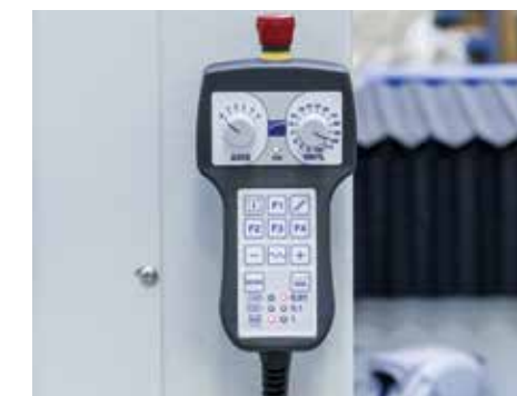
Pulsantiera remota per controllo fino a 6 assi che consente di operare vicino al piano di taglio e di impostare multiorigini.
