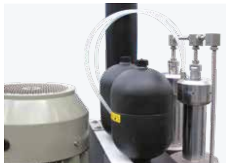
Accumulatore d'azoto per la gestione del circuito di ritorno dei cilindri idraulici
