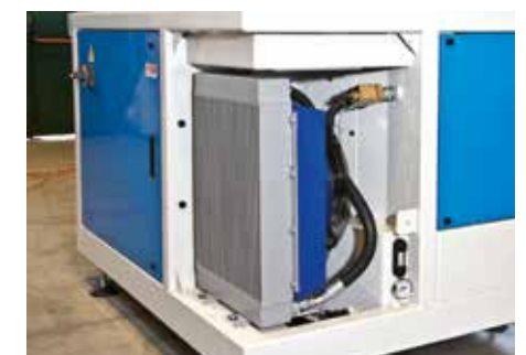
Scambiatore di calore aria/olio
