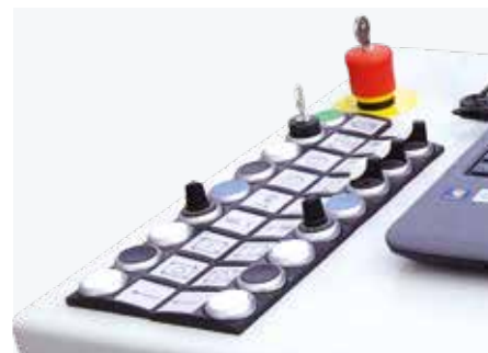
Controllo della pressione e del funzionamento dell'intensificatore gestito direttamente dalla consolle
