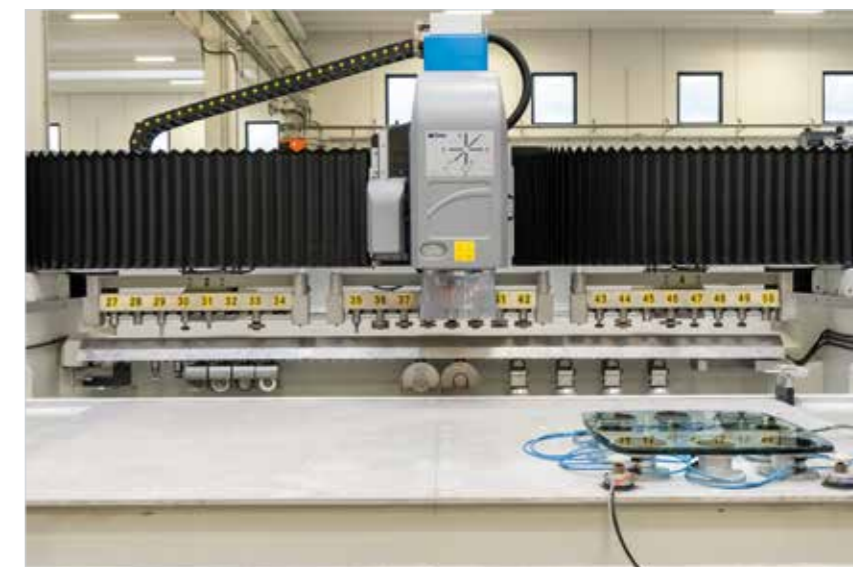
Portautensili sottotrave fino a 24 posizioni di coni
