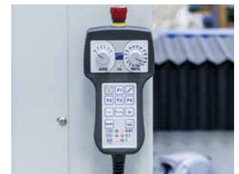
Pulsantiera remota per controllo fino a 6 assi che consente di operare vicino al piano di taglio e di impostare multiorigini.
